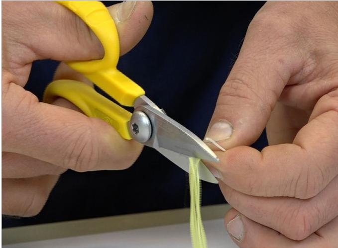
Después de pelar la cubierta de fibra, use las tijeras KS-1 de Kevlar® marca Miller® para cortar los miembros resistentes Kevlar®.
